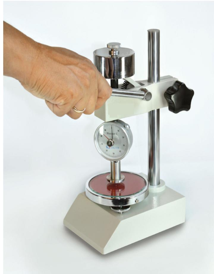
Per entrambe i modelli è disponibile un supporto (**modello TI**), costituito da una robusta struttura metallica e da una colonna di acciaio inossidabile che sostiene il durometro. La parte superiore dell'asta è dotata di manopola di bloccaggio ed è provvista di peso aggiuntivo.
